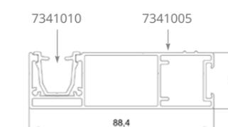
Guida singola standard per il sistema F-A.
