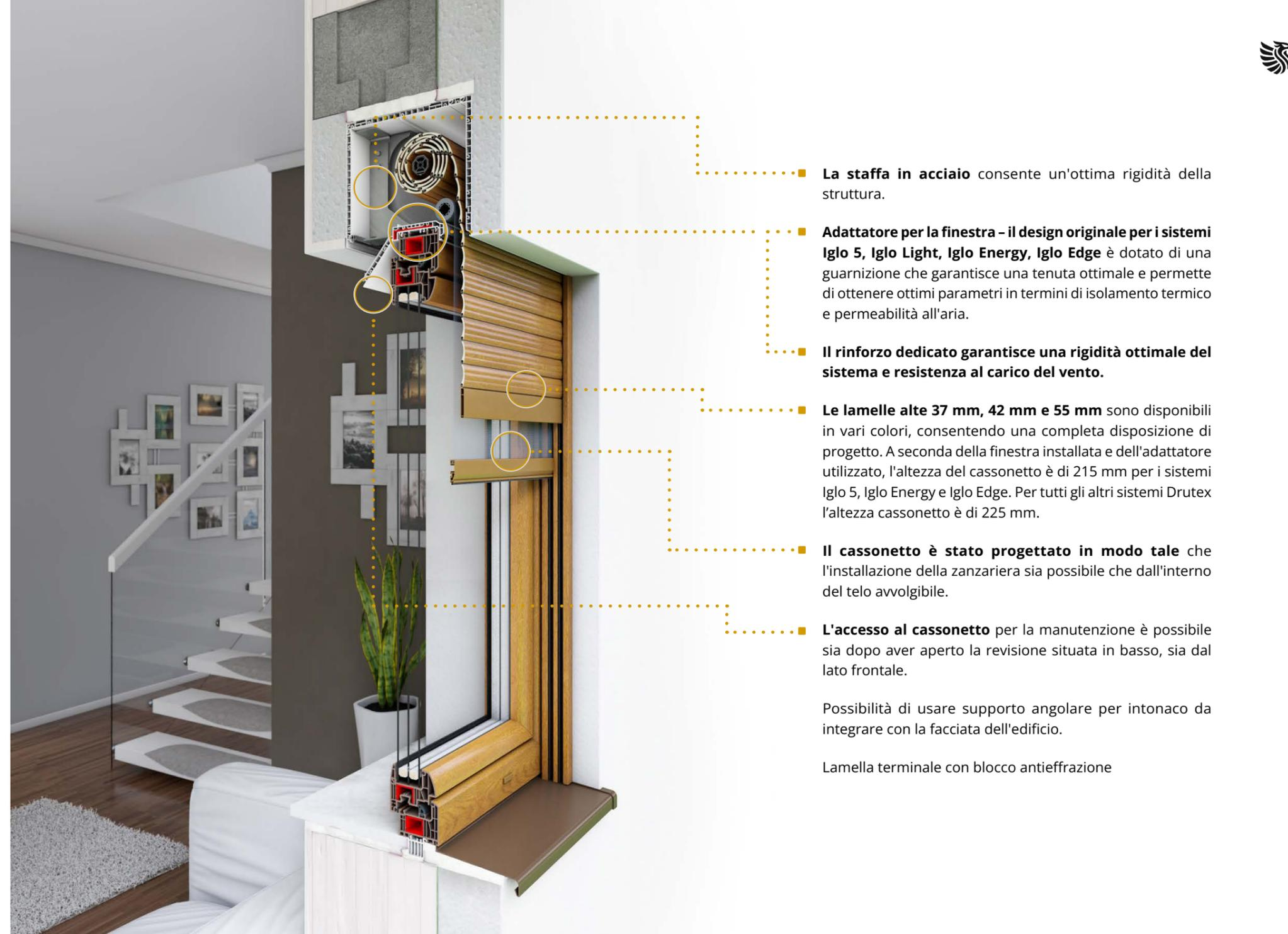
■ **La staffa in acciaio** consente un'ottima rigidità della struttura.
